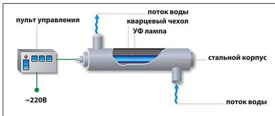
Схема ультрафиолетового обеззараживания воды
